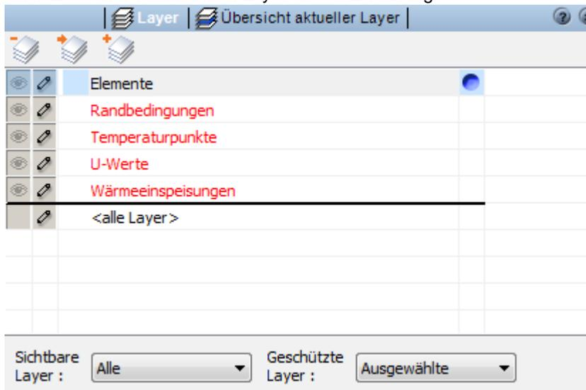
Layer, die durch das Zeichnen von Elementen mit fixer Layerzuordnung entstanden sind, werden rot dargestellt. Freie, durch den Benutzer angelegte Layer, sind schwarz.
