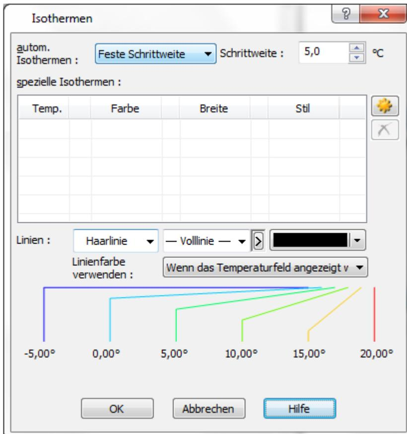
Für die automatischen Isothermen stehen die Optionen **Feste Schrittweite**, **Feste Anzahl** oder **Keine** zur Auswahl. Wird **Keine** gewählt, werden nur selbst hinzugefügte Isothermen angezeigt.
