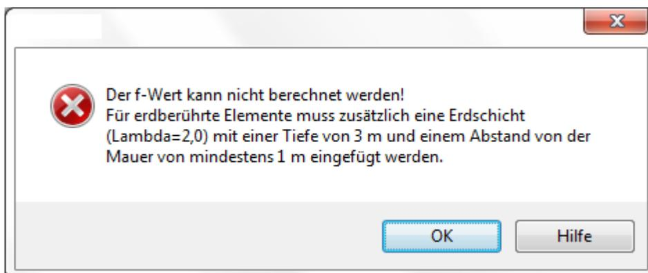
Bei der f-Wert-Berechnung muss zusätzlich eine Erdschicht ( $\lambda = 2,0$ ) mit einer Tiefe von 3 m und einem Abstand von der Mauer von mindestens 1 m eingefügt werden ([siehe Randbedingungen](#)).
