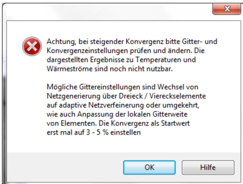
Bei Verwendung der adaptiven Netzverfeinerung kann es besonders bei größeren Querschnittsänderungen bei weiterer Netzverfeinerung zum Ansteigen der Konvergenz führen. Mögliche Abhilfe:
