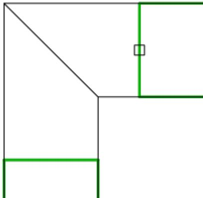
Klicken Sie auf die Kanten der zu trimmenden Polygone. Es werden beide Polygone aneinander getrimmt.
