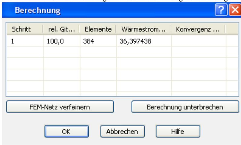
sollte die erwünschte Konvergenz in der maximalen Schrittzahl nicht erreicht sein, kann mit **FEM-Netz verfeinern** die Berechnung fortgesetzt werden.
