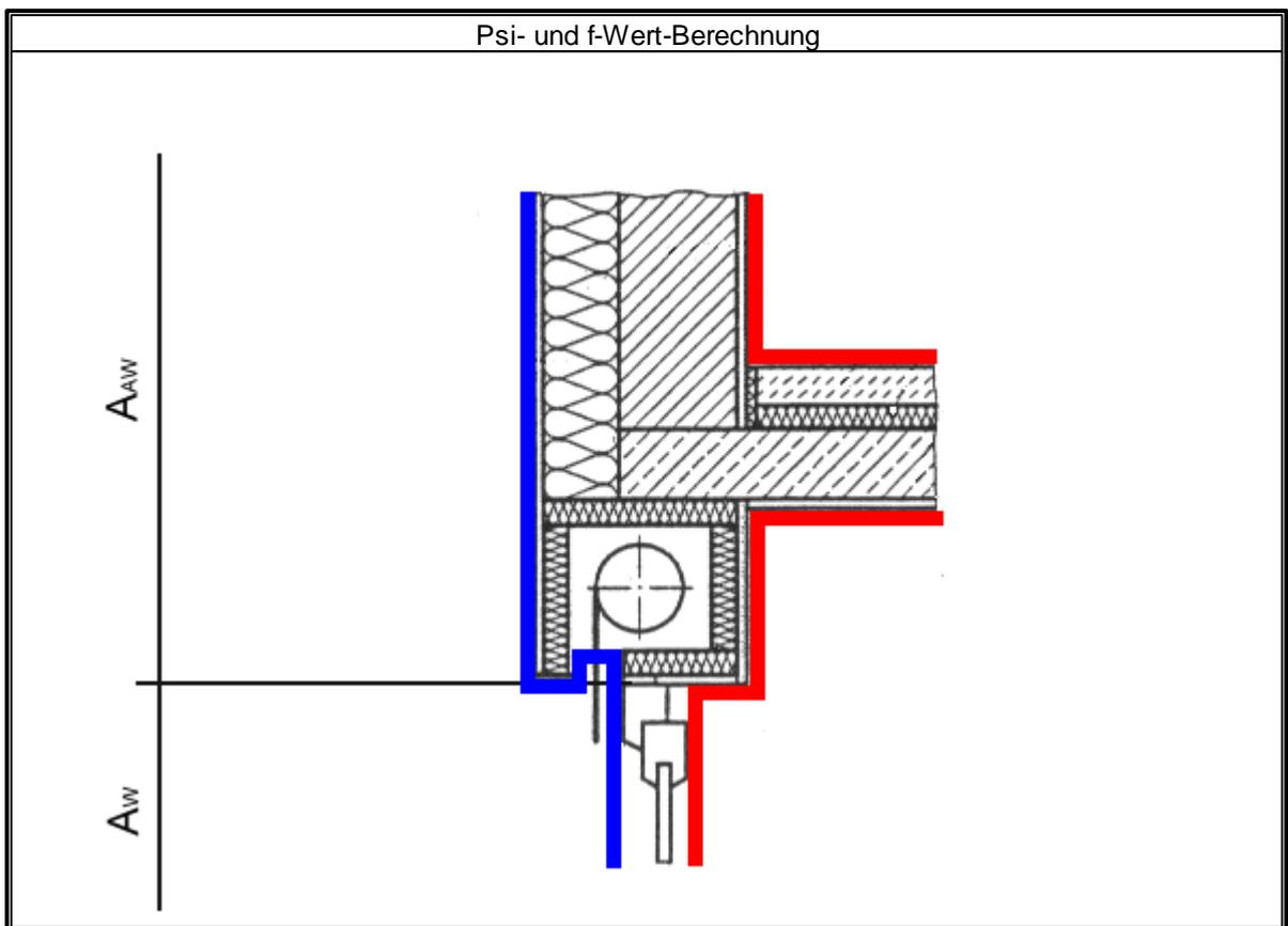
Für den Hohlraum ist ein Luftelement mit  $\lambda_{eq}$ -Wert nach DIN EN ISO 10077-2 (leicht belüftet) einzubauen.
