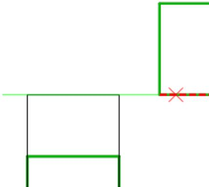
Klicken Sie auf die Kante des zu trimmenden Polygons. Mit dem 2. Klick bestimmen Sie die Bezugskante, zu der das Polygon getrimmt werden soll.
