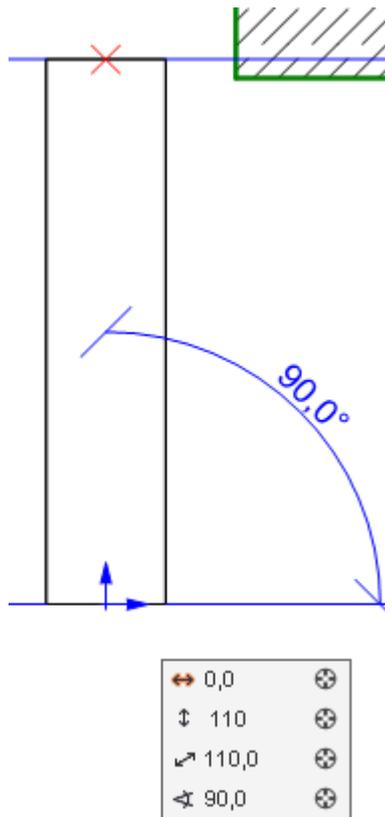
Fügen Sie die beiden Elemente zusammen, indem Sie die Betondecke mit
