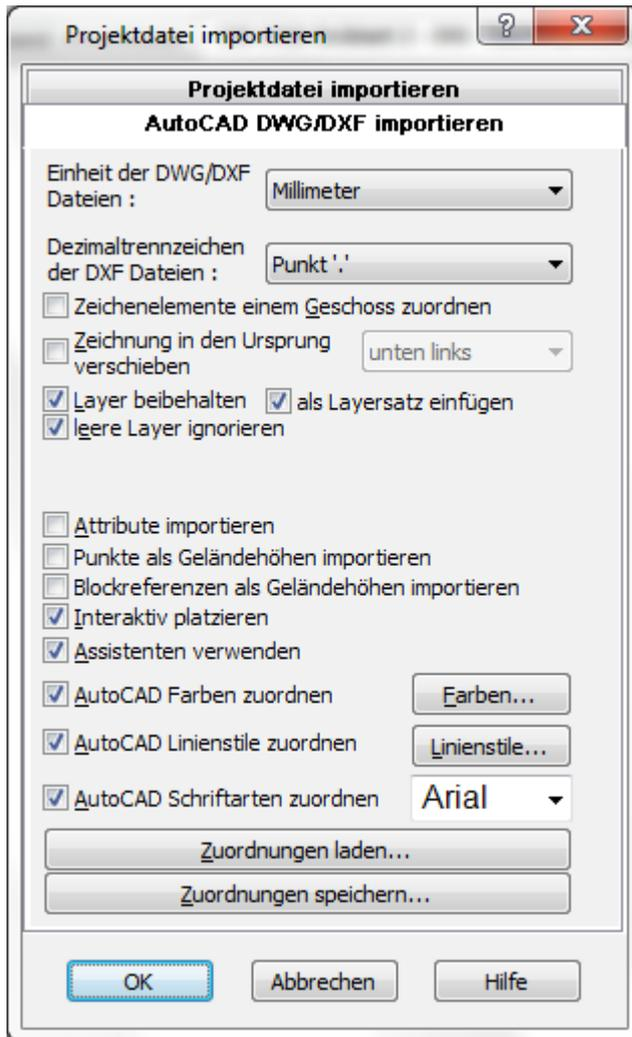
Wählen sie die Einheit, beachten sie die Informationen über Abmessungen (Breite und Höhe) und Lage des Imports. Damit kann die richtige Einheit abgeschätzt werden. Bei nicht nachvollziehbaren Abmessungen ist es sinnvoll, erst einen ‚Probeimport‘ zu starten und in dieser Datei eine bekannte Strecke in der BKI Wärmebrückenplaner 3 Zeichnung zu messen, damit kann die Importeinheit abgeschätzt und gegebenenfalls korrigiert werden
