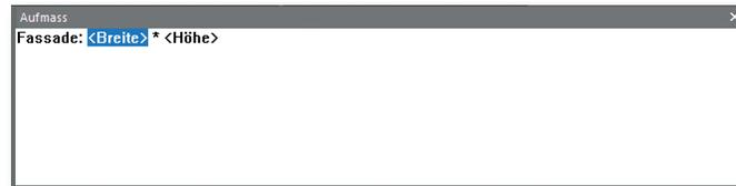
Der erste Parameter der Formel ist blau hinterlegt und kann aus dem Bild gemessen werden. Dazu wählen Sie die Art der Messung, z.B. Strecke messen und greifen die zu messende Strecke ab. Der Wert wird im Datenfenster eingetragen und der nächste Parameter wird blau hinterlegt. So fahren Sie fort, bis alle Parameter gemessen wurden.
