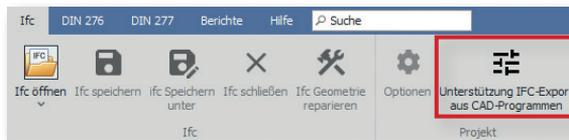
ABB. 4-2: AUSWAHL DER CAD-KONFIGURATION FÜR DEN IFC-EXPORT
