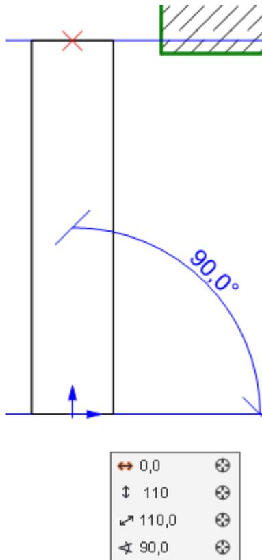
Fügen Sie die beiden Elemente zusammen, indem Sie die Betondecke mit
