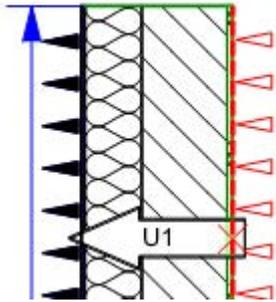
Der U-Wert wird berechnet.
