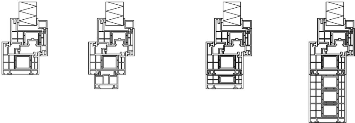
Zum Verfahren ist es zuerst erforderlich, entsprechend der relevanten Schnittebene des Fensters (halbe Breite, halbe Höhe) den U-Wert des Referenzbauteils zu bestimmen.
