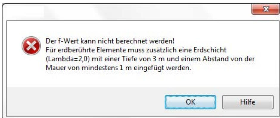
Bei der f-Wert-Berechnung muss zusätzlich eine Erdschicht ( $\lambda = 2,0$ ) mit einer Tiefe von 3 m und einem Abstand von der Mauer von mindestens 1 m eingefügt werden.
