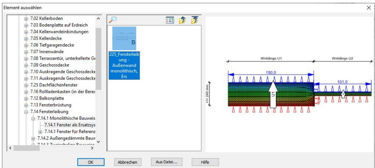
Mit diesen Werten wird dann der Zuschlagswert ermittelt und auf den errechneten Psi-Wert des Details mit Ersatzsystem addiert.
