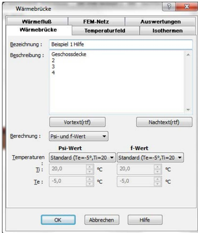
Unter **FEM-Netz** wird die Gitterweite festgelegt.
