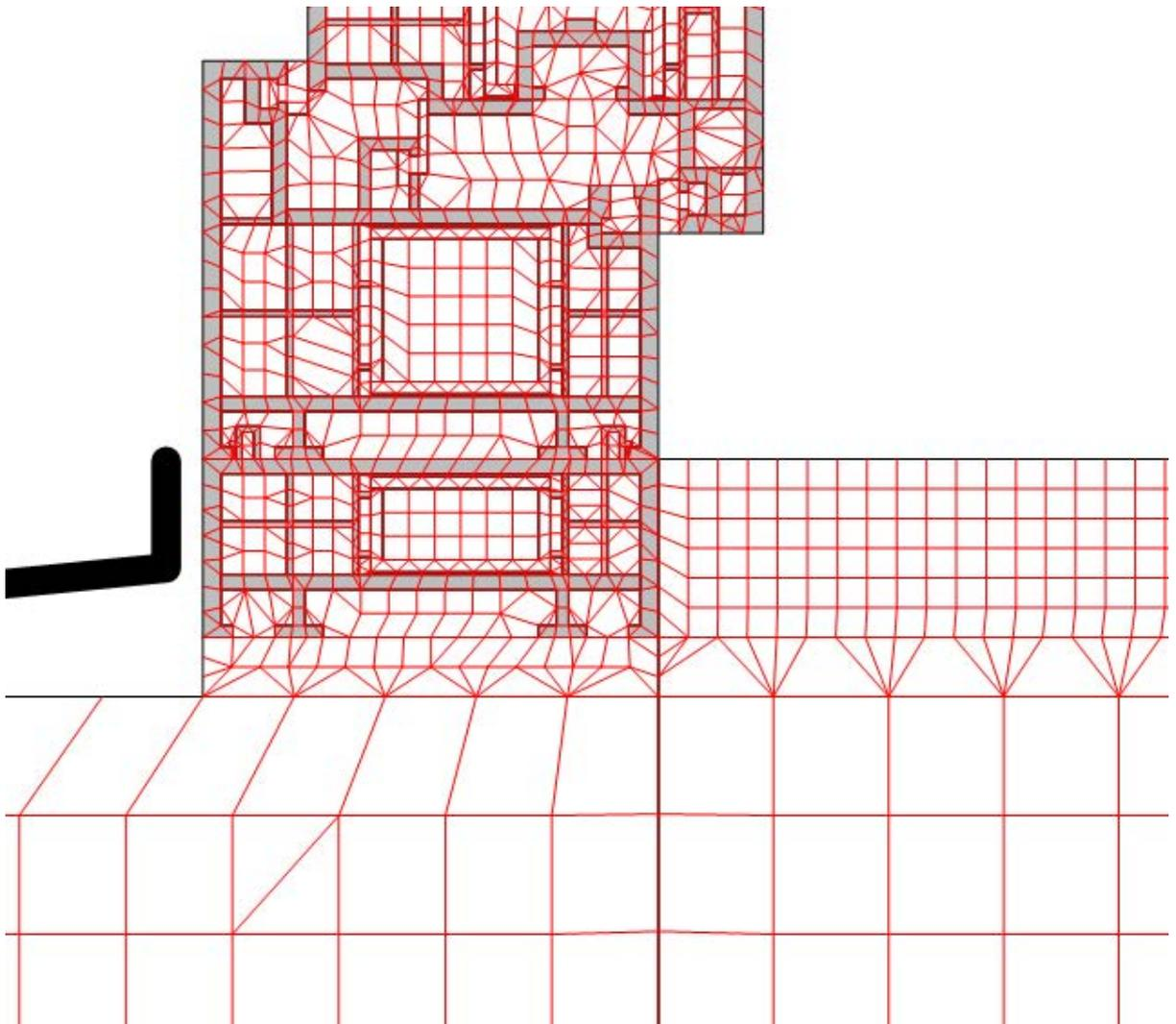
Die Wärmebrücke kann nun berechnet werden.
