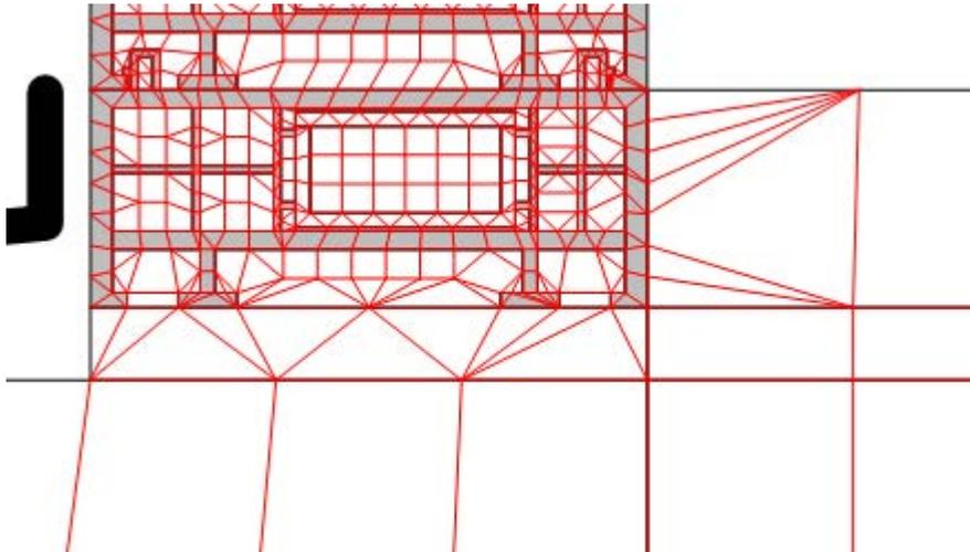
Ändern Sie bei den angrenzenden Bauteilen die Gitterweite auf absolut 0,5 cm.
